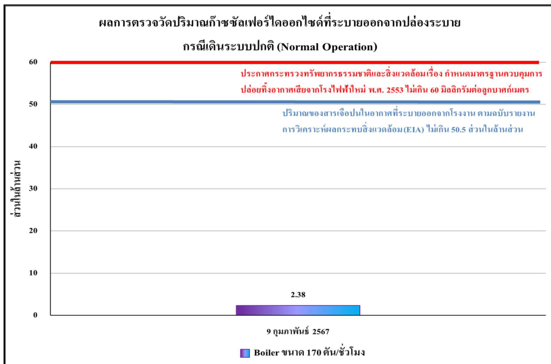
รูปที่ 4.3.1-8 ผลการตรวจวัดปริมาณก๊าซซัลเฟอร์ไดออกไซด์ที่ระบายออกจากปล่อง (ช่วงหีบอ้อย) กรณีเดินระบบปกติ (Normal Operation) ของ Boiler ขนาด 170 ตัน/ชั่วโมง
